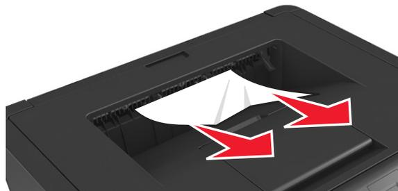
2 Wählen Sie auf dem Bedienfeld des Druckers **Weiter** > **OK** > **Beseitigen Sie den Stau und drücken Sie "OK"** > **OK** aus, um die Meldung zu löschen und den Druckvorgang fortzusetzen.
