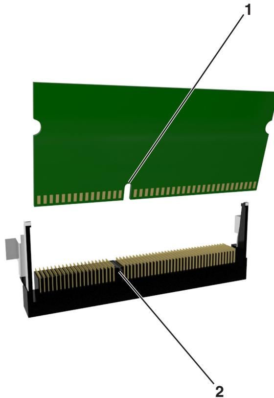
4 Drücken Sie die Speicherkarte gerade in den Steckplatz und schieben Sie die Karte dann in Richtung der Controller-Platinenwand, bis sie *hörbar* einrastet.
