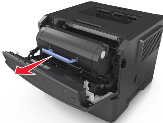
3 Heben Sie den blauen Hebel an und ziehen Sie dann die Belichtungseinheit aus dem Drucker heraus.
